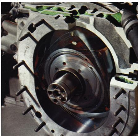
Il motore a pistone rotante della Spider.
