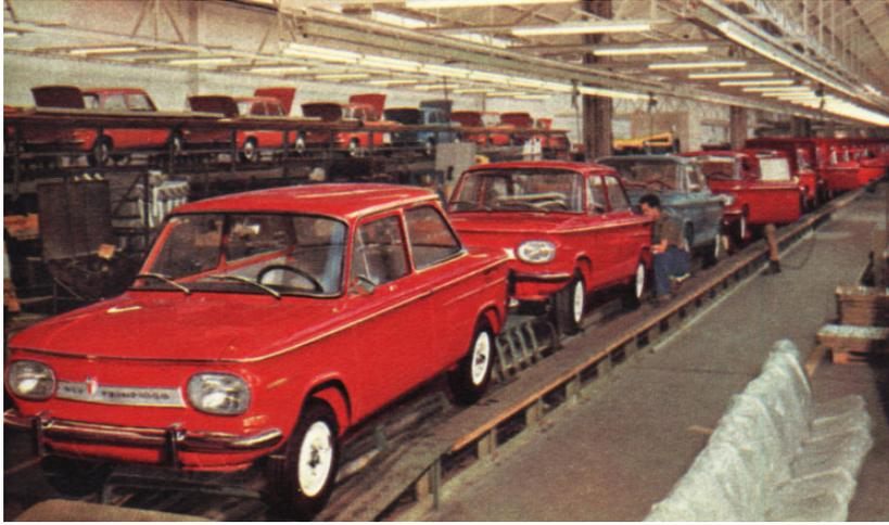
Sul convogliatore a nastro finale viene montata la vettura.
